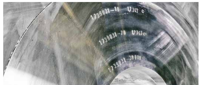
▲ Rezipient für Aluminium-Strangpressen mit Q10 Innenbüchse
