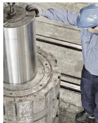
Aus- und Einschrumpfen von Innen- und Zwischenbüchsen ▼
