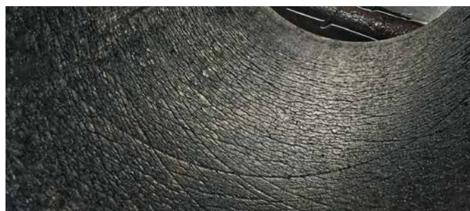
SA718 (1250 – 1400 MPa) nach 150.000 Cu-Pressbolzen, feines Rissnetzwerk
