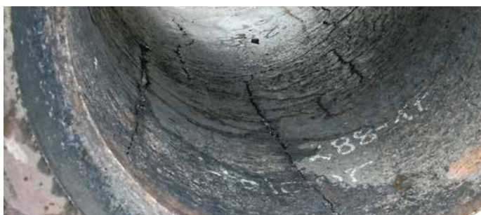
HWF (1000 – 1150 MPa) nach 30.000 Cu-Pressbolzen, grobes Rissnetzwerk mit Ausbrüchen
