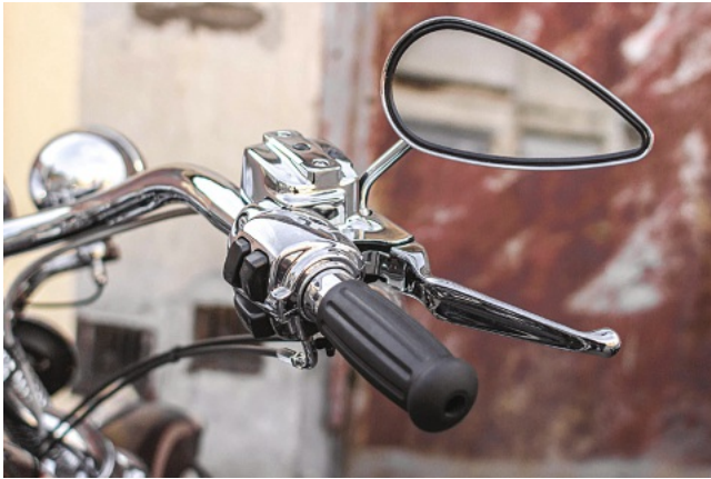
Bild 7: Druckgegossener Behälter für die Bremsflüssigkeit eines Motorrads (Beispiel).
