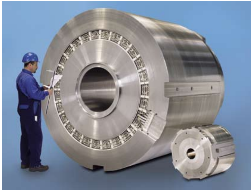
Blockaufnehmer für 150-MN- und 15-MN-Strangpresse im Vergleich Containers for 150-MN and 15-MN extrusion presses by comparison
