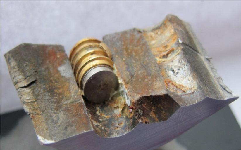
Bei geringen Abständen der Kühlungen zur Formenoberfläche besteht bei Wasserkühlungen die Gefahr korrosionsbedingter Leckagen!
