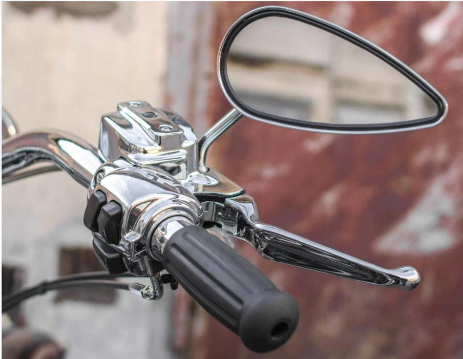
Flüssigkeitstank für eine Motorrad-Bremse
