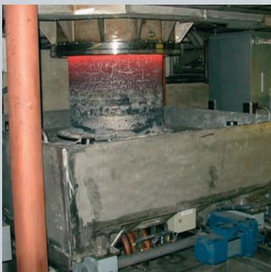
Gleittiegel mit absenkbarer Bodenplatte
