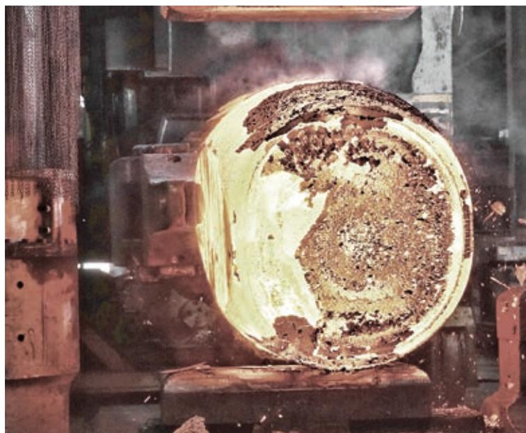
Forja de un bloque por proceso ESR en la prensa 30MN. ▲
