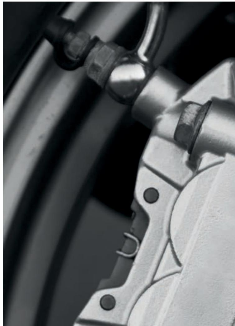
▲ 摩托车的铝合金制动卡钳
