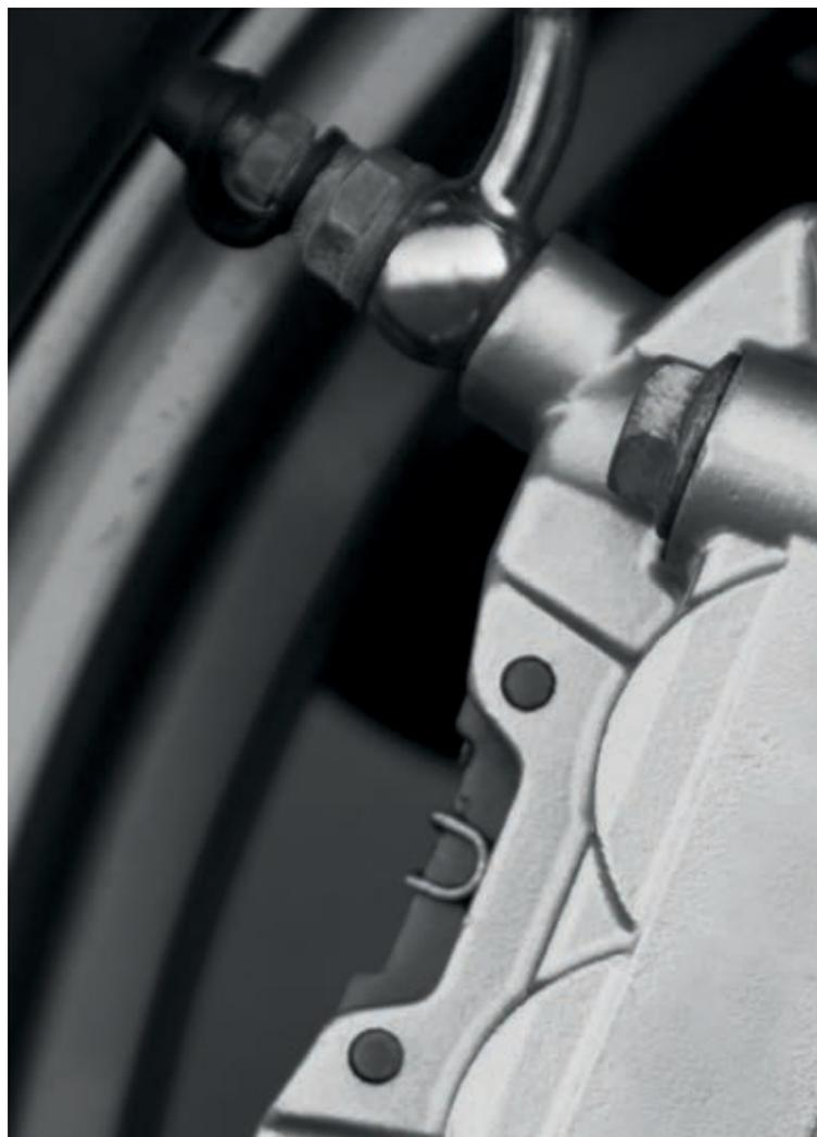
▲ Pinza de freno de una motocicleta fabricada en aleación de aluminio
