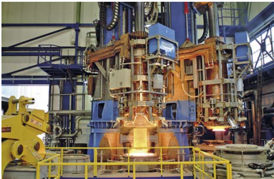
ESU-Umschmelzanlage zur Herstellung von hoch beanspruchten Strangpreßwerkzeugen ESR furnace for the production of highly stressed extrusion tools
