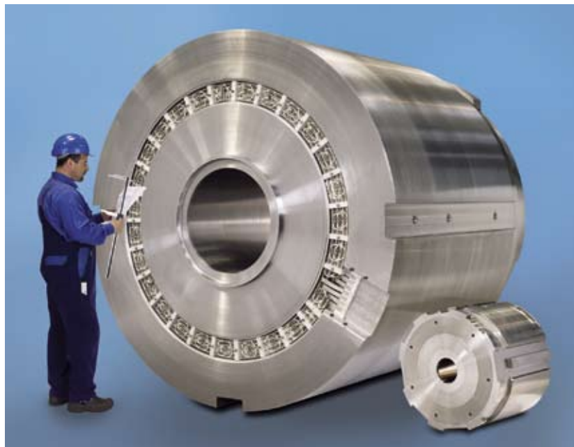
Blockaufnehmer für 150-MN- und 15-MN-Strangpresse im Vergleich Containers for 150-MN and 15-MN extrusion presses by comparison
