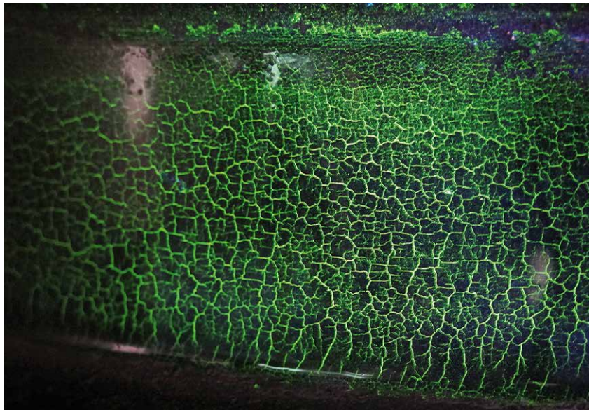
Bild 1: Temperaturwechselrisse auf der Oberfläche einer Druckgießform, sichtbar gemacht im Magnetpulver-Test unter UV-Licht.
